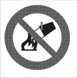
Verboden met water te blussen
